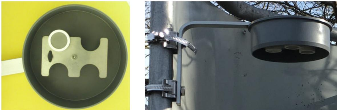
**Abbildung 7:** Ein Ferm-Passivsammler im Einsatz.<sup>46</sup> Pro Messpunkt werden immer mindestens zwei Messungen durchgeführt und gemittelt, um die Messgenauigkeit zu erhöhen.
