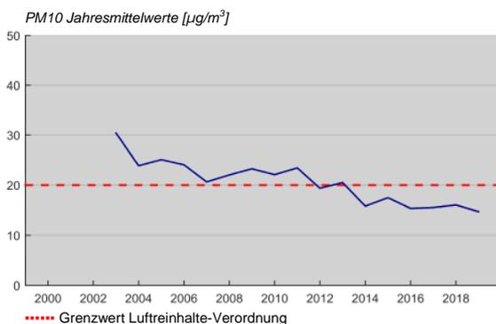
Die Station Reiden ist wie die Station A2 Uri Bestandteil des MfM-U-Messnetzes. Mit den erhobenen Messdaten soll die durch das bilaterale Landverkehrsabkommen zwischen der Schweiz und der EU (Verlagerung des Schwerverkehrs auf die Schiene) verursachte Veränderung der Luftqualität quantifiziert werden. Verkehrsmengen, Fahrzeugklassen und Lärmimmissionen werden hier zusätzlich erfasst. Die Ozonmessung wurde Ende 2006 aufgrund des geänderten MfM-U-Messkonzeptes eingestellt.
