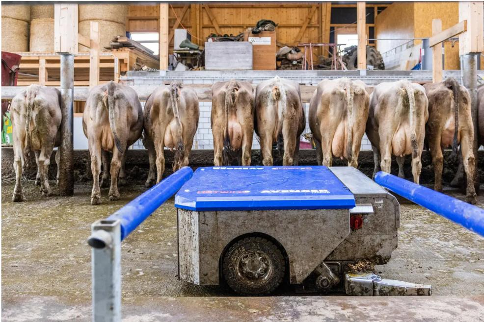
Der erste Musterstall zur Reduktion von Ammoniakemissionen ist fertiggestellt, er steht im schwyzerischen Merlischachen. Im Bild der Entmistungsroboter im Einsatz.
