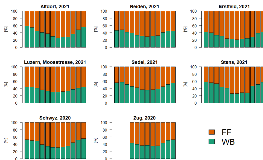
Abbildung 67: Ergebnisse aus dem Aethalometer-Modell: Relative Russwerte, aufgeteilt in die Quellen «ff» (fossil fuel), welche auf Verkehr hindeuten, und «wb» (wood burning), welche auf Holzheizungen hinweisen.
