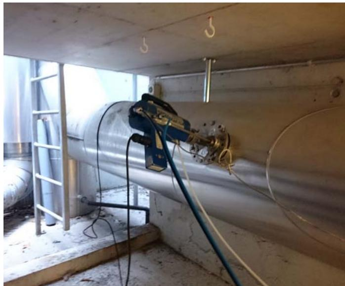
Mess-Sonde am Kamin: Eine spezielle Messtechnik ermöglicht die lückenlose Datenerfassung über mehrere Tage.
