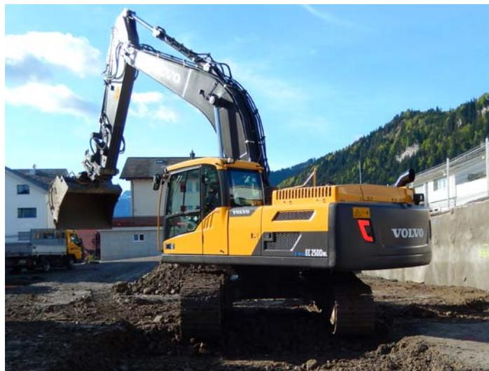
Mustergültiges Aushubgerät mit eingebautem Partikelfilter.
