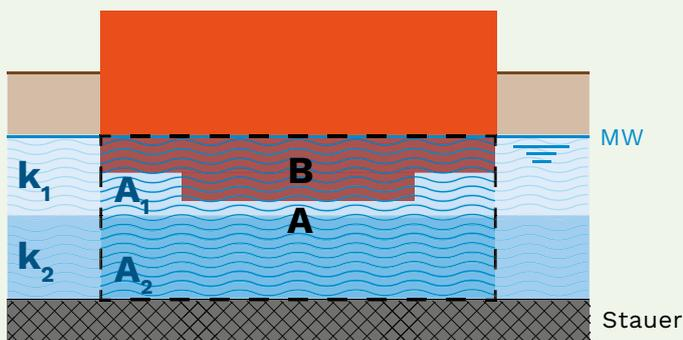
**A** durchströmte Fläche des Grundwasserleiters im natürlichen Zustand unterhalb des mittleren Grundwasserspiegels MW (100%);
