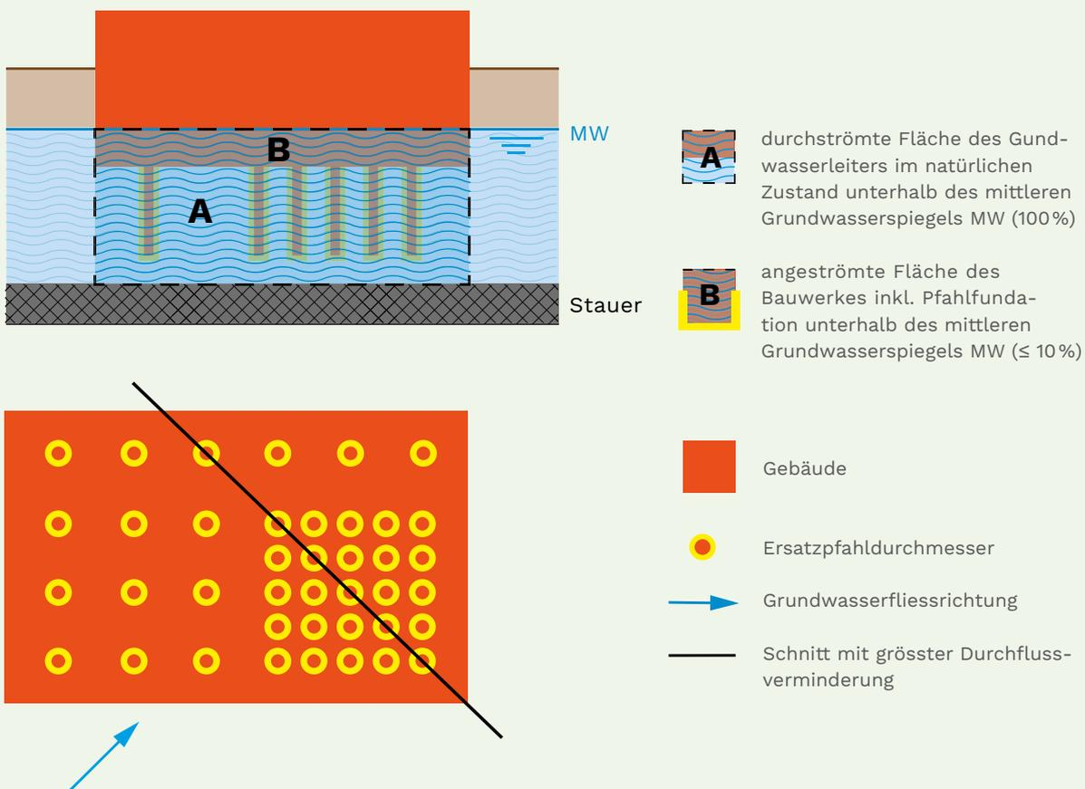
Alle Pfähle (inkl. Verdrängungsbereiche), die durch die Schnittlinie berührt werden, müssen in die Berechnung einbezogen werden.
