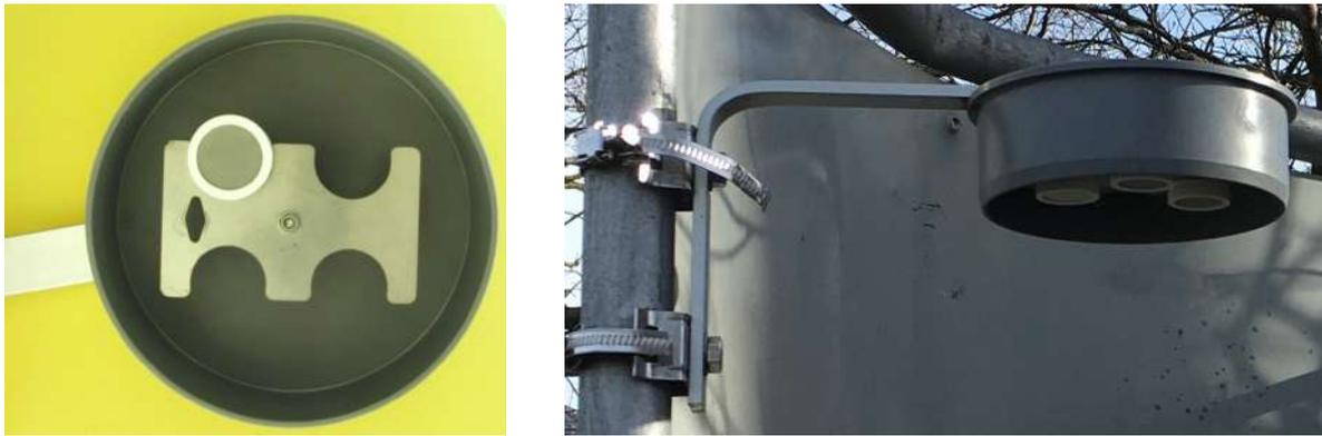
**Abbildung 5:** Ein Ferm-Passivsammler im Einsatz.<sup>35</sup> Pro Messpunkt werden immer mindestens zwei Messungen durchgeführt und gemittelt, um die Messgenauigkeit zu erhöhen.
