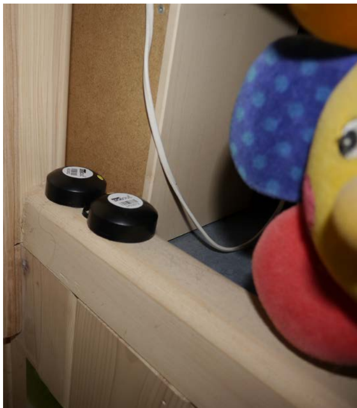
In einem Schlafzimmer aufgestellte Dosimeter für eine 12-Monate dauernde Messung.
